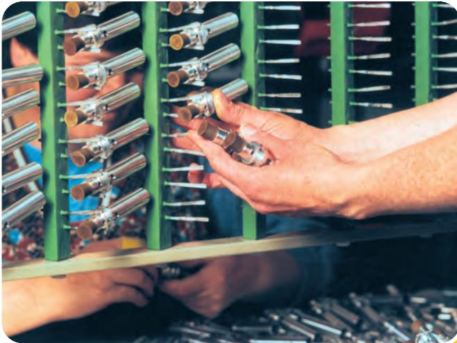
Gestellbestückung von Steuerkolben für eine HART-COAT®-Beschichtung
