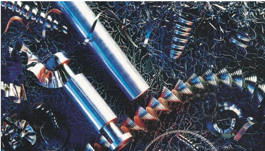
Bild 11: Beispiele von Spanausbildungen bei unterschiedlichen Schwefelgehalten
